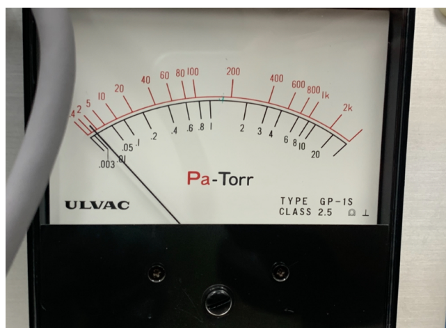
Figure7: ピラニゲージのメモリ。0.003Torr 付近では針の「振れ」に対する圧力値の変化が大きく、正確な圧力値の読み取りに大きな不確かさが伴うと考えられる。
